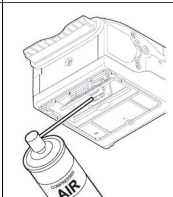
Bild 65 Entfernen Sie vor der Reinigung mit Druckluft Papierüberreste und Papierstaub aus dem Cutterfach.
