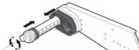
Bild 41 Um die Papierbreite zwischen 60 bis 82,5 mm anzupassen, drehen Sie den Knopf.
