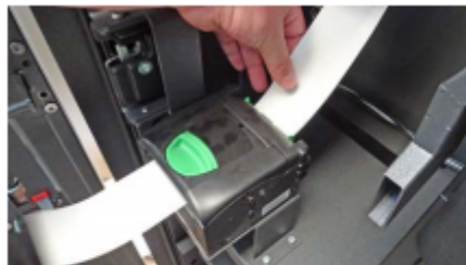
Bild 40 Der Papierschnitt erfolgt nach erfolgreichem Einzug automatisch.
