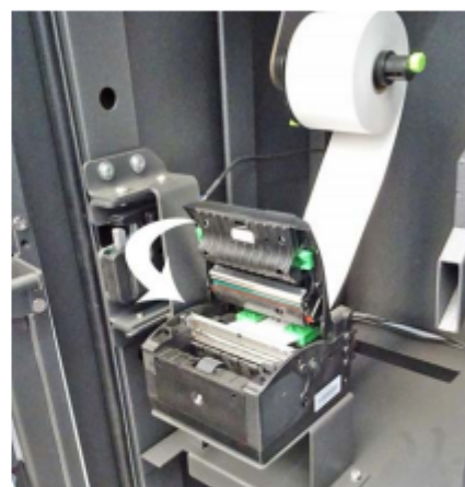
Bild 43 Schließen Sie die Klappe wieder bis sie hörbar einrastet. Der Papiereinzug startet automatisch und schneidet ab. Im Bedarfsfall muss das Papier noch zugeführt werden (siehe Bild 38).
