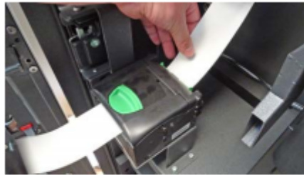
Bild 40 Der Papierschnitt erfolgt nach erfolgreichem Einzug automatisch.
