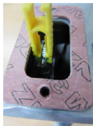
Bild 6 Entnehmen Sie mit der Zange die Sicherung. Tauschen Sie gegen eine Passende aus und setzen Sie diese wieder mit der Zange ein.
