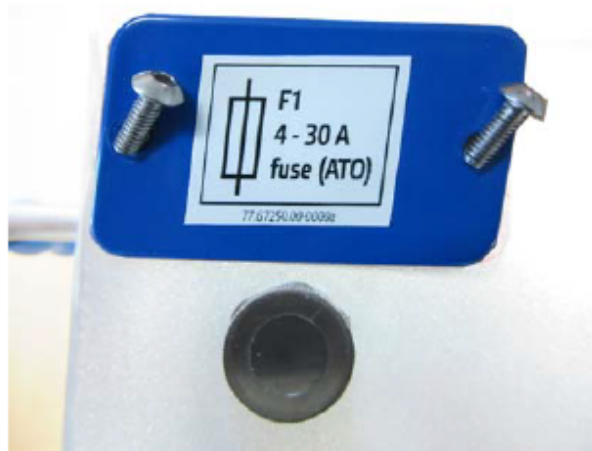
Bild 7 Setzen Sie den Deckel wieder auf und schrauben Sie ihn mit den beiden Schrauben mit 0,9 Nm wieder an.
