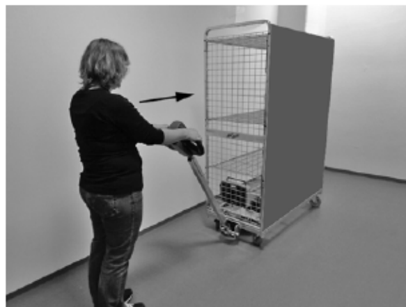
Bild 11 ... halten Sie die Bedieneinheit mit beiden Händen.
