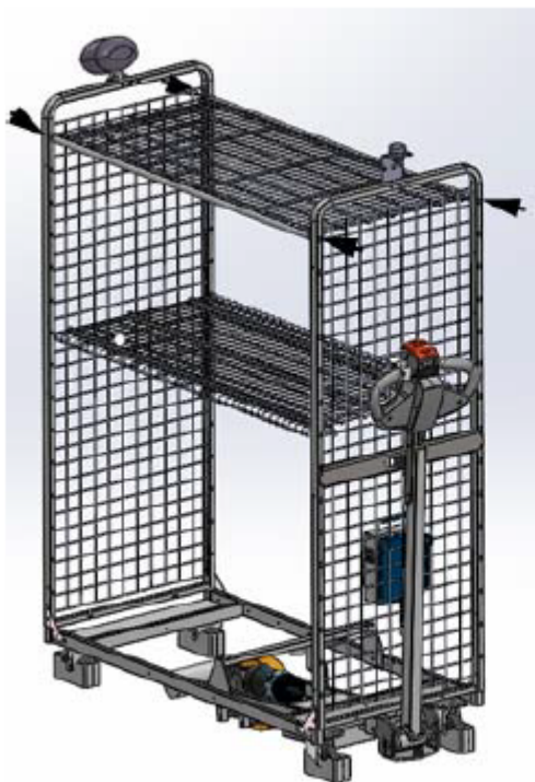
Bild 34 Schrauben Sie die Etage wieder fest.
