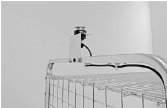
Bild 16 Gelbe Leuchte blinkt im Rückwärtsbetrieb.
