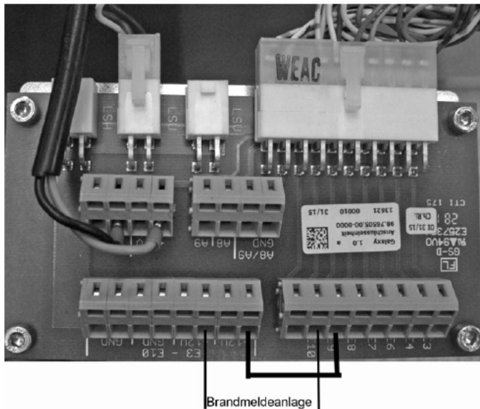
Schritt3: Schließen Sie den potentialfreien Kontakt der Brandmeldeanlage zwischen+12V und E10 an (siehe Funktionstabelle).
