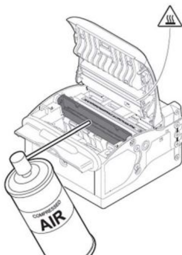
Bild 63 Reinigen Sie den Cutter mit Druckluft.
