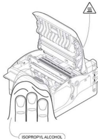
Bild 61 Reinigen Sie die Walzen mit einem nicht-abrasiven Tuch befeuchtet mit Isopropyl Alkohol.
