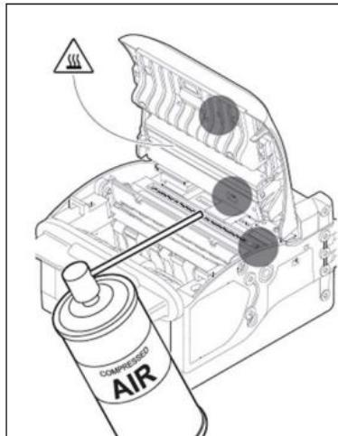
Bild 58 Reinigen Sie die Sensoren des Geräts mit Druckluft.
