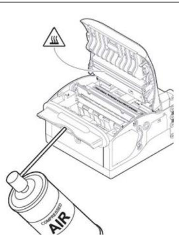
Bild 59 Entfernen Sie vor der Reinigung mit Druckluft Papierüberreste, Staub auf den Papieröffnungen, auf der Druckerrolle, dem Cutter und dem Bereich um die Sensoren.
