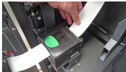
Bild 40 Der Papierschnitt erfolgt nach erfolgreichem Einzug automatisch.
