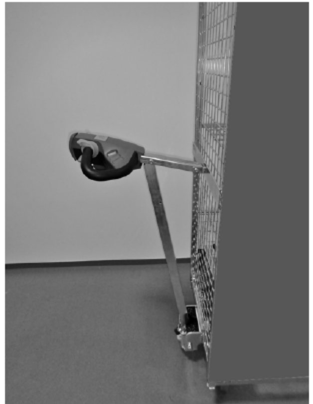
Bild 2 Betrieb mit starrer Deichsel
