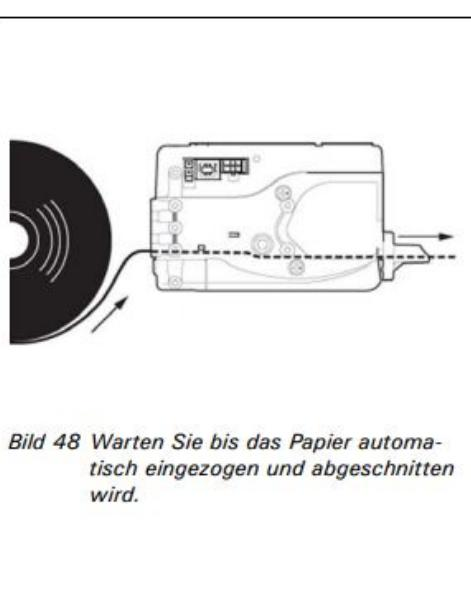
*Bild 48 Warten Sie bis das Papier automatisch eingezogen und abgeschnitten wird.*
