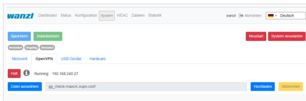
Wenn der Start erfolgreich war, wechselt die Farbe von grün nach rot und die Beschriftung von Start zu Halt. Rechts neben dem Info-Symbol wird der Status des OpenVPN-Clients angezeigt sowie die IP-Adresse für den Zugriff im VPN-Netzwerk für dieses Gate eingblendet. Man kann den Fernzugriff deaktivieren, indem man den Button **Halt** klickt.
