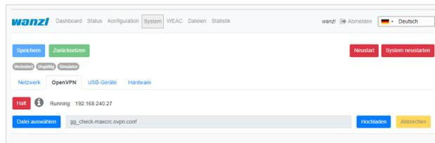
Wenn der Start erfolgreich war, wechselt die Farbe von grün nach rot und die Beschriftung von Start zu Halt. Rechts neben dem Info-Symbol wird der Status des OpenVPN-Clients angezeigt sowie die IP-Adresse für den Zugriff im VPN-Netzwerk für dieses Gate eingeblendet. Man kann den Fernzugriff deaktivieren, indem man den Button **Halt** klickt.
