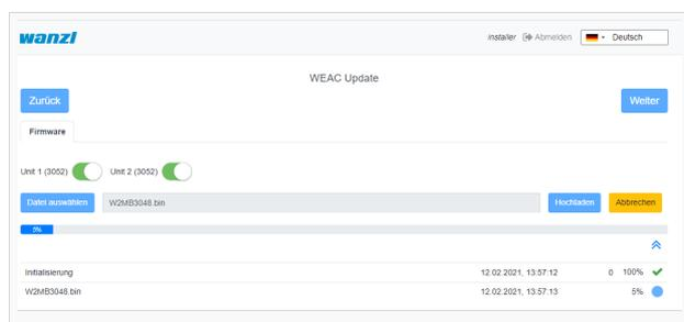
Nach dem Prüfen der WEAC-Firmware werden die Schwenktüren konfiguriert. Dabei wird automatisch geprüft, ob die Mindestvoraussetzungen bzgl. der Firmware erfüllt werden. In der Oberfläche wird man darüber informiert, wenn zunächst die Firmware aktualisiert werden muss.
