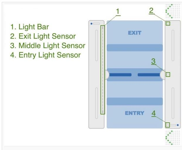
Die Lichtleiste dient als Quelle für mehrere Signale und ist ebenfalls in unterschiedliche Bereiche unterteilt.
