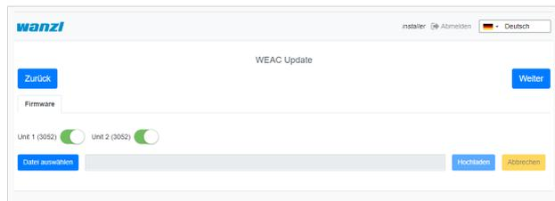
Die Version der Firmware für jede Unit wird als Label neben dem Aktivierungsbutton aufgeführt. Während des Aktualisierungsvorganges werden die Navigationsmöglichkeiten deaktiviert. Der Aktualisierungsprozess dauert ca. 3 Minuten für beide Units.
