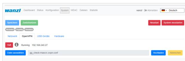
Wenn der Start erfolgreich war, wechselt die Farbe von grün nach rot und die Beschriftung von Start zu Halt. Rechts neben dem Info-Symbol wird der Status des OpenVPN-Clients angezeigt sowie die IP-Adresse für den Zugriff im VPN-Netzwerk für dieses Gate einblendet. Man kann den Fernzugriff deaktivieren, indem man den Button **Halt** klickt.
