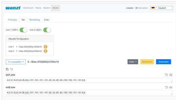
Hier kann man aus verschiedenen Konfigurationen die zutreffende Größe der Schwenktür auswählen. Mit dem Klick auf **Anwenden** werden die angezeigten Dateien übertragen. Der aktuelle Fortschritt der Dateiübertragung wird angezeigt.
