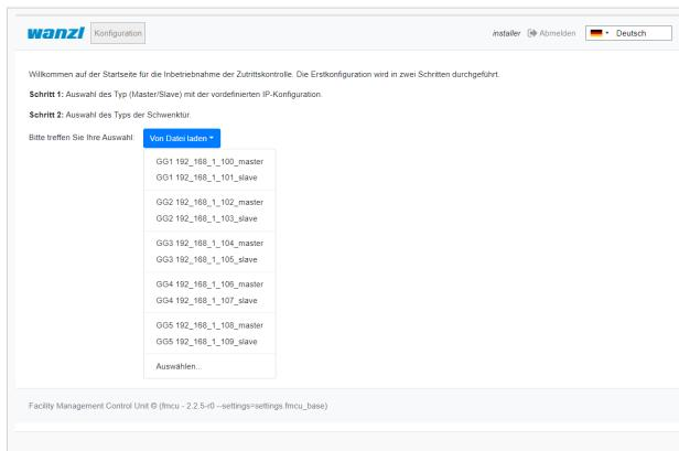
Man kann hier zwischen unterschiedlichen Konfigurationen auswählen, um mehrere Zutrittskontrollen parallel einzurichten. Nach Auswahl einer Konfigurationsdatei für Master oder Slave wird die Anwendung neu gestartet und man kann jetzt den Typ der Schwenktür auswählen. Nachdem die Auswahl bestätigt worden ist, startet die Anwendung neu und man befindet sich im Konfigurationsschritt 2.
