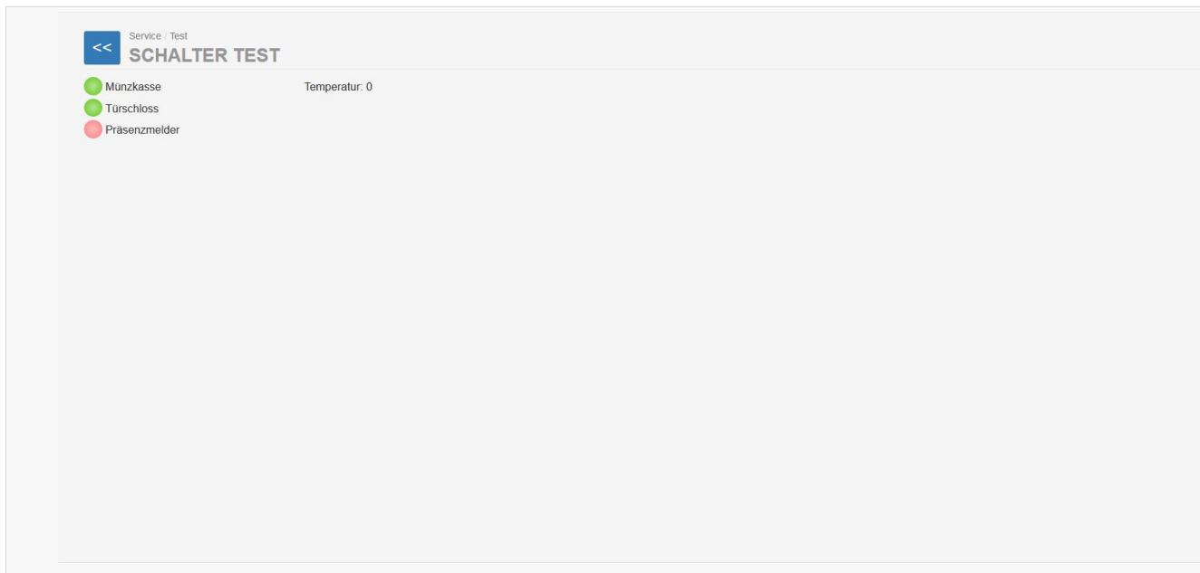
In "Eingänge/Schalter" wird eine Übersicht von der Münzkasse, dem Türschloss und dem Präsenzmelder angezeigt. Die grüne Farbe steht dabei dafür, dass das Gerät aktiv ist, während der rote Kreis für eine Inaktivität steht.
