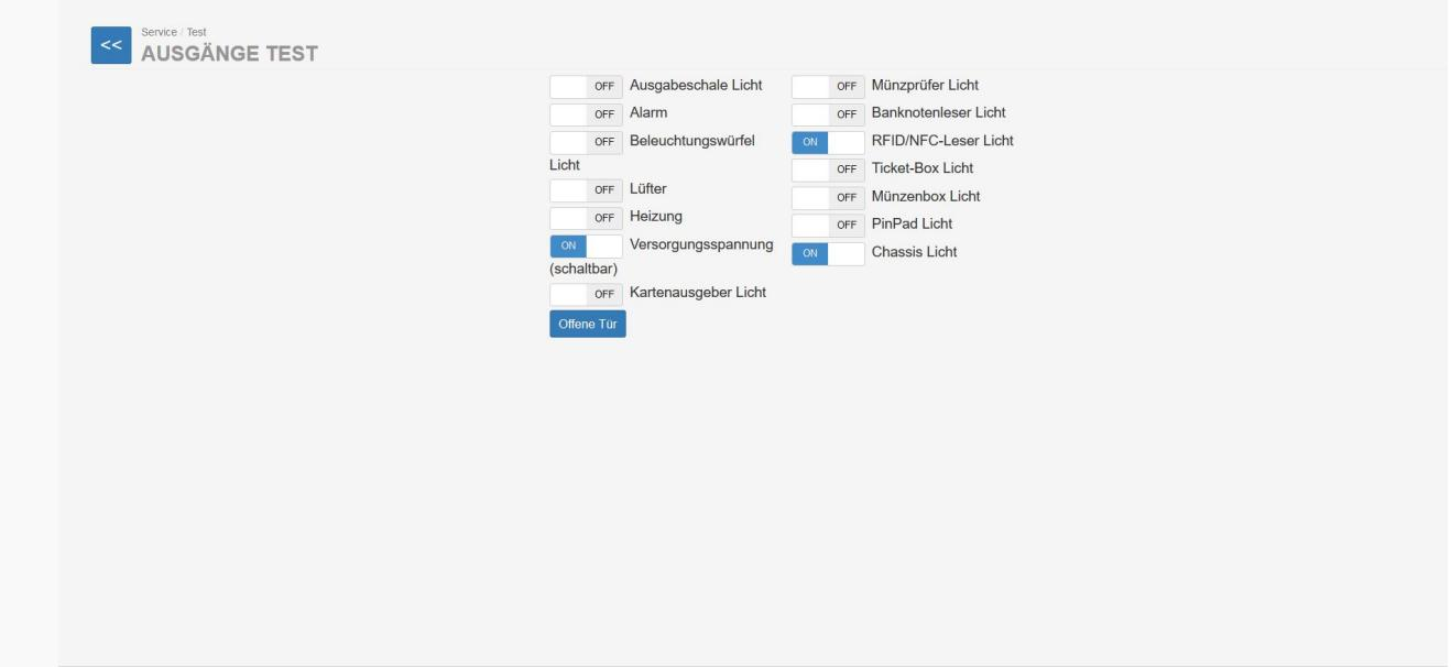
In "Ausgänge" liegt der Fokus dabei zu einem die verschiedenen Lichter zu Prüfen (hierfür den Schalter auf "ON" richten). Zum anderen ist es möglich die Heizung, die Lüftung und die Versorgungsspannung zu testen. Außerdem kann die Tür, mittels der Schaltfläche "Offene Tür", die Tür vollständig geöffnet werden.
