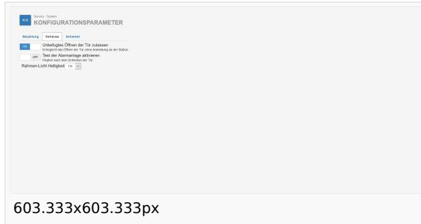
Hier kann das unbefugte Öffnen und den Testton der Alarmanlage aktiviert oder deaktiviert werden.
