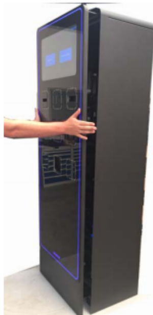
Bild 15 Drücken Sie die Türe bis zur vollständigen Einrastung zu. Legen Sie die Hände flach auf die Seite. Beachten Sie die Quetschgefahr!
