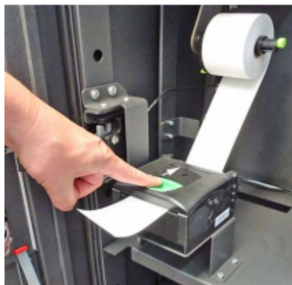
Bild 41 Drücken Sie den grünen Betätigungshebel zum Schrankinneren bis sich die Klappe Bild 41 öffnet.
