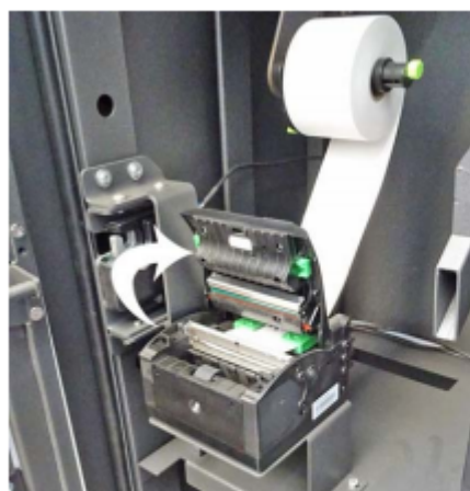
Bild 42 Öffnen Sie die Klappe um ca. 80 Grad und entfernen Sie anschließend ggf. Fremdkörper oder beseitigen Sie den Papierstau.
