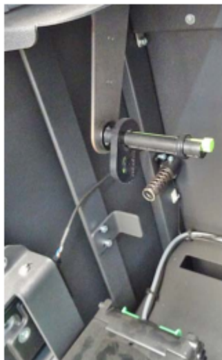
Bild 36 Rollenhalter ohne Papierbestückung
