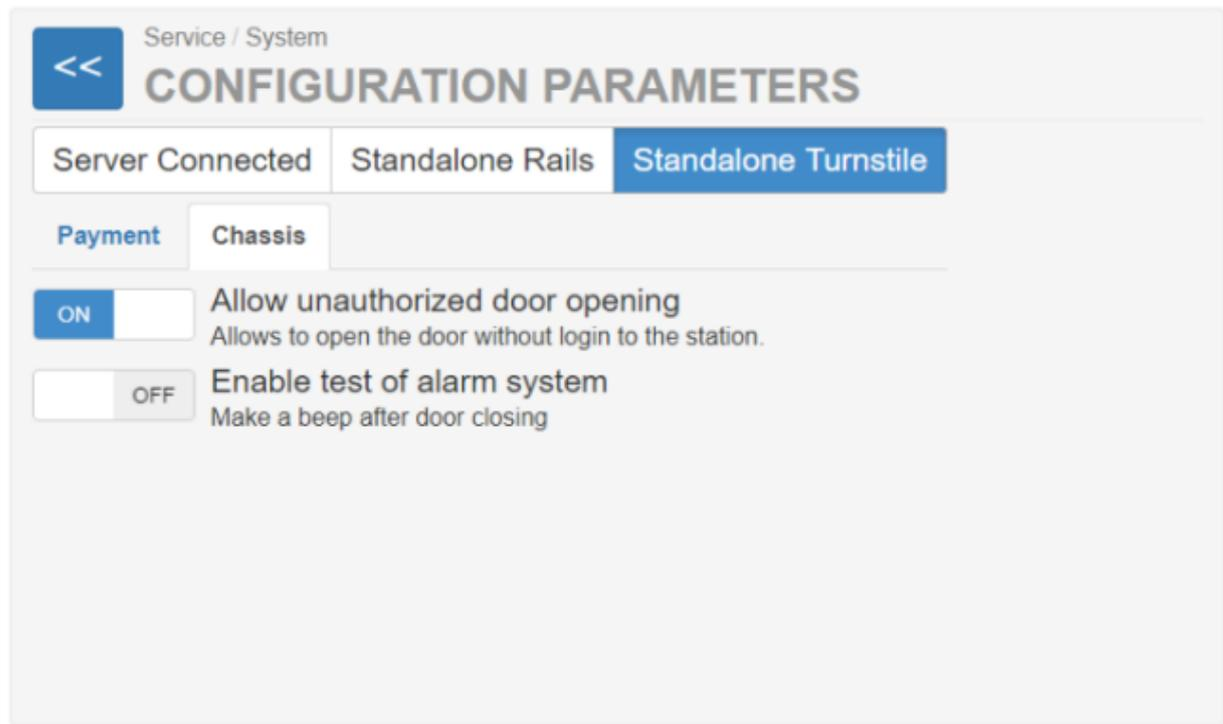
**Bild 5 Die Registrierkarte/der Reiter Chassis im Einzelbetrieb Drehkreuz**
