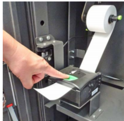
Bild 41 Drücken Sie den grünen Betätigungshebel zum Schrankinneren bis sich die Klappe Bild 41 öffnet.
