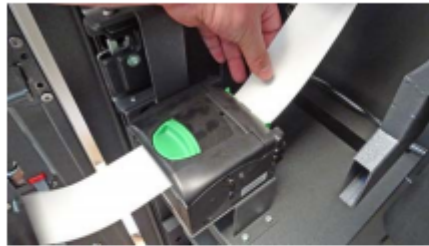
Bild 40 Der Papierschnitt erfolgt nach erfolgreichem Einzug automatisch.
