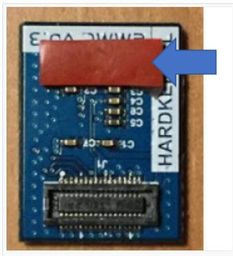
Richten Sie das eMMC Modul und den eMMC-Anschluss auf der ODROID-C2-Platine bündig aus, wobei das weiße Rechteck auf der Platine als Richtlinie dient.
