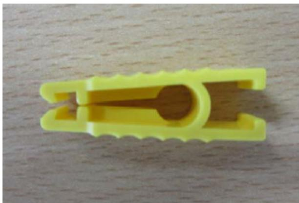
**Bild 5** Zange für die Sicherung
