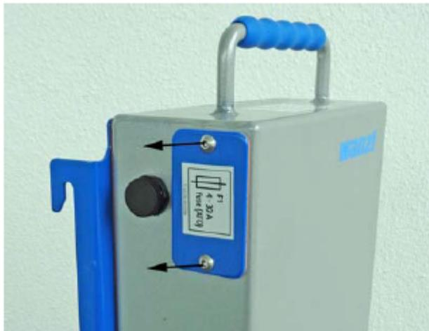
*Bild 3 Entfernen Sie die Sicherungsabdeckung*
