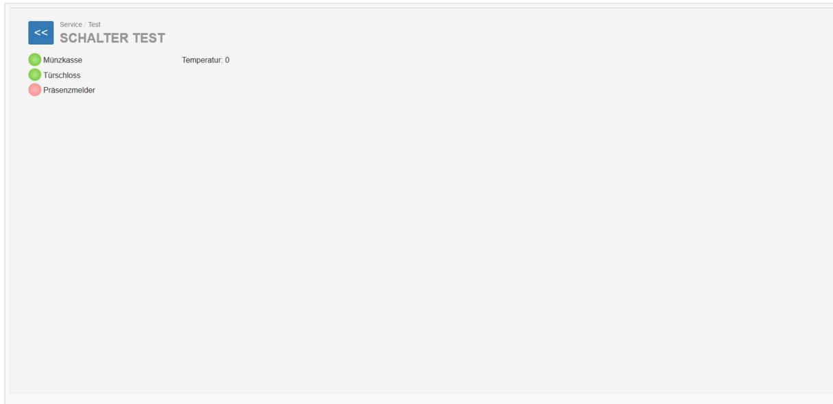
In "Eingänge/Schalter" wird eine Übersicht von der Münzkasse, dem Türschloss und dem Präsenzmelder angezeigt. Die grüne Farbe steht dabei dafür, dass das Gerät aktiv ist, während der rote Kreis für eine Inaktivität steht.
