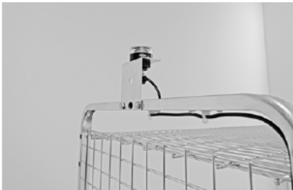
Bild 16 Gelbe Leuchte blinkt im Rückwärtsbetrieb.
