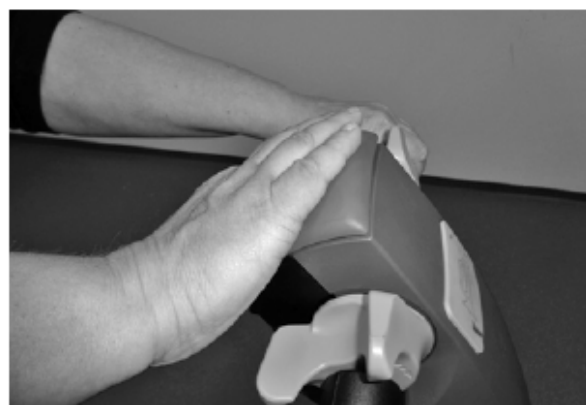
Bild 15 Bei kurzem Kontakt stoppt der Antrieb und macht eine Richtungsänderung.
