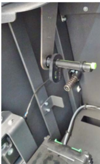
Bild 36 Rollenhalter ohne Papierbestückung
