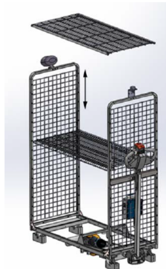
Bild 33 Positionieren Sie die Etage je nach Bohrungen im Holm.
