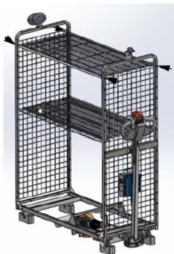
Bild 34 Schrauben Sie die Etage wieder fest.
