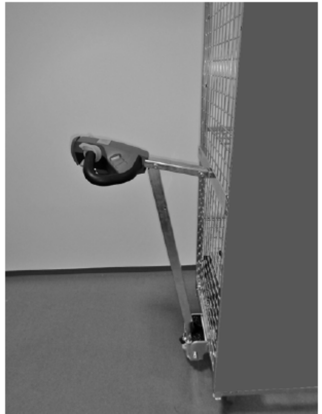
Bild 2 Betrieb mit starrer Deichsel
