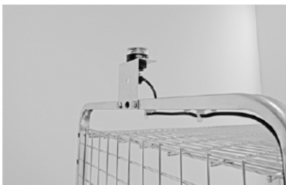
Bild 16 Gelbe Leuchte blinkt im Rückwärtsbetrieb.
