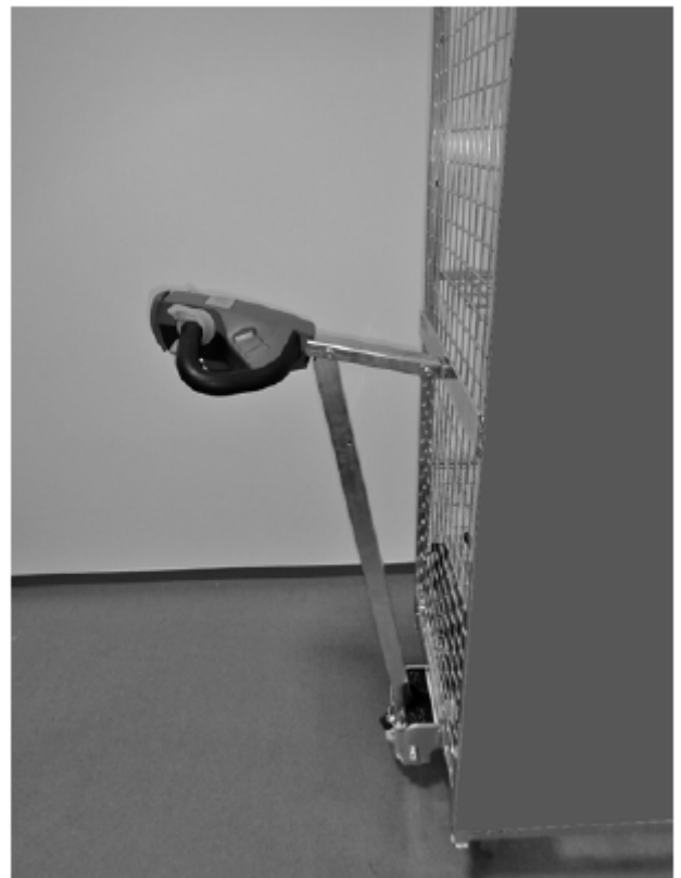
Bild 2 Betrieb mit starrer Deichsel
